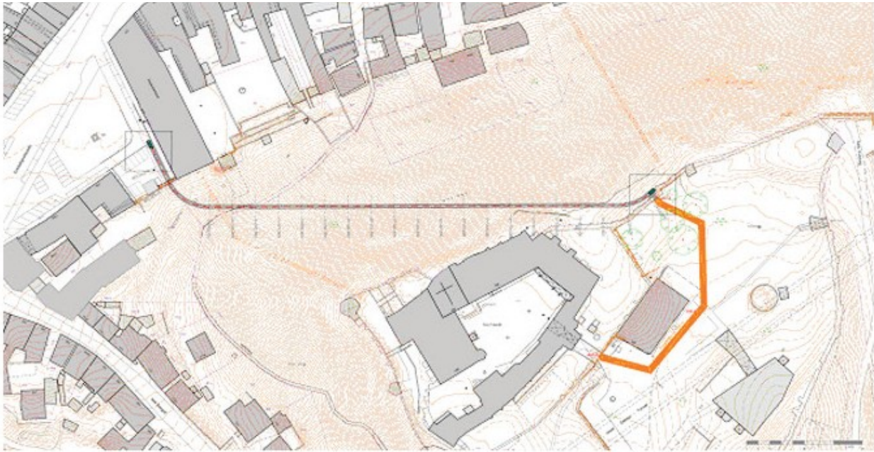
Abb 4c. Lageplan des Schrägaufzugs (Planung: BBI Ingenieure)
